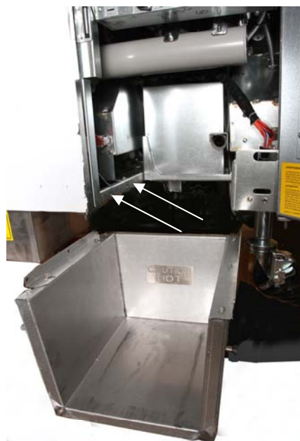
Slika 1: Položaj taljenje enoto v omari pritrdite z vijaki, ki v notranjosti omare.
